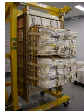
補給ラックにCTBを取り付けたところ
