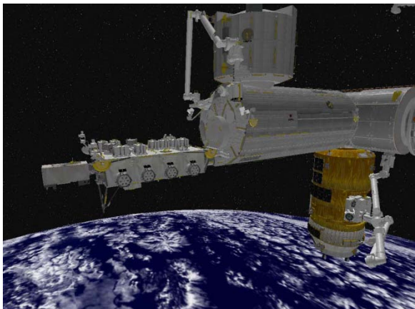
HTVから曝露パレットをISSロボットアームにより取り外す
