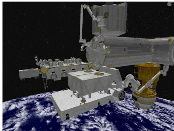
曝露パレットを船外実験プラットフォームに移送する
