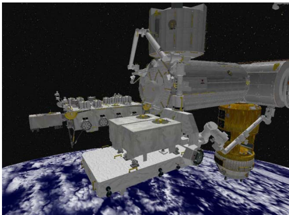
曝露パレットを「きぼう」ロボットアームに引き渡す
