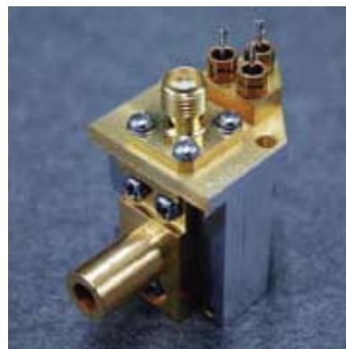
超伝導ミキサ (サブミリ波帯観測信号からマイクロ 帯に出力する)
