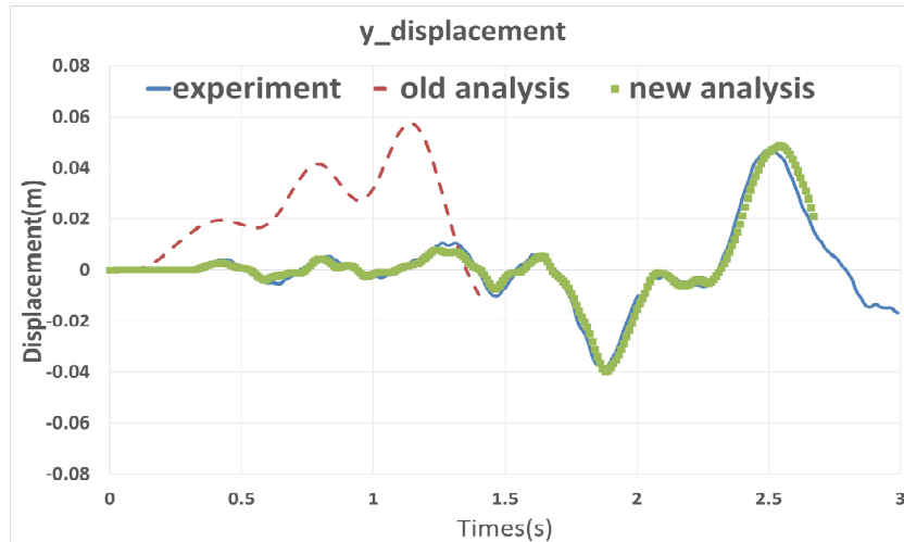
図 2 鉄筋コンクリート橋脚の地震応答の実験結果と解析結果の比較。供試体の細部を無視した場合 (old analysis) は精度が低いですが、細部まで正確にモデル化した場合 (new analysis) は実験結果を高い精度で再現できる。
