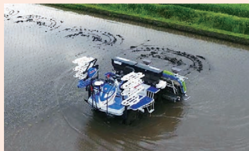
無人作業中の自動運転田植機
