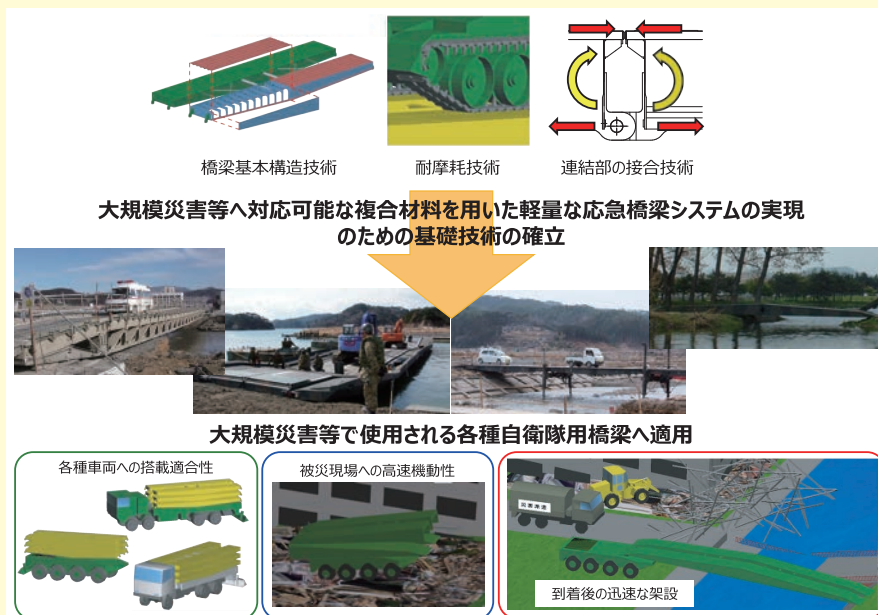
第2-3-7図 将来 きょうりょう 軽量橋梁構成要素の研究試作
