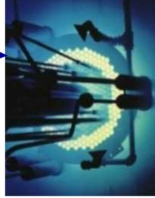
実機燃料と同じ太さの試験燃料棒を装着し、カプセル上部に配置した高速カメラでの観察により燃料破損メカニズムを解明し、シビアアクシデントへの進展防止等の検討に必要な技術的知見を取得
