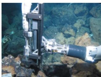
熱水鉱床の成分分布を測定するセンサーについて、水深 3,000m まで使用可能なシステムを開発し、沖縄海域の深海底において複数元素をリアルタイムで検出。
