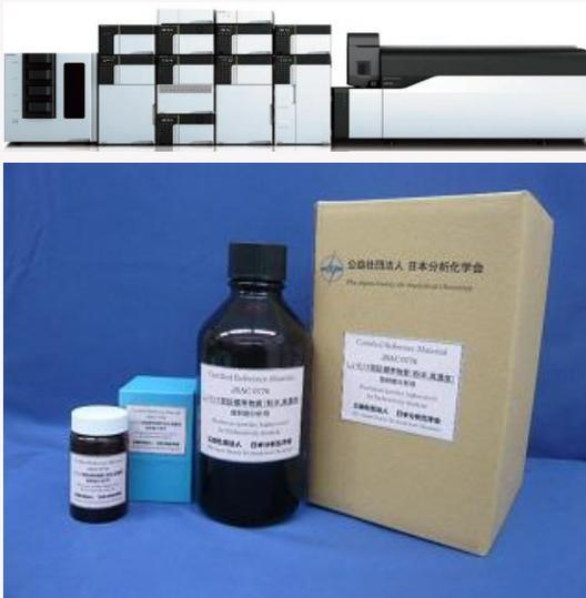
上：超臨界流体技術を用いて試料の前処理操作と高速・高分離分析を全自動化した分析システム（有機溶媒の使用量を大幅に削減し、不安定な試料も熟練の技術を要さず前処理、分離、検出を高感度・高速かつ自動で行える）の開発
