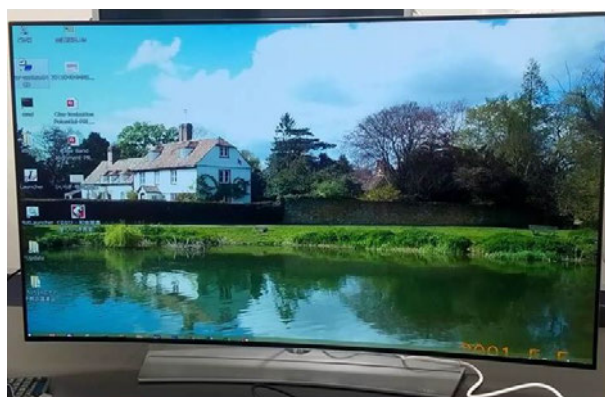
IGZO-TFTで駆動する55インチ、4Kの 有機ELテレビ 提供：細野研究室
