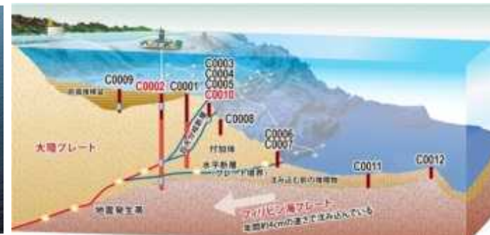
南海トラフ地震発生帯掘削計画概要図
