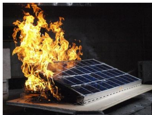
太陽電池モジュールの火炎曝露 ばくろ 実験 提供：消防研究センター
