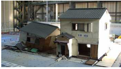
Eディフェンスによる震動実験
