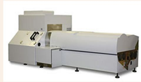
左：リアルタイムステレオ走査型電子顕微鏡（リアルタイムに裸眼で3次元観察が可能な顕微鏡。医学・生物学から無機材料の分野まで幅広い応用が期待される）
