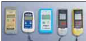
② 空間の放射線量を調べる 簡易放射線測定器「はかるくん」(シンチレーション式サーベイメータ) 空間の放射線量を測るもの。身の回りの放射線(ベータ(β)線、ガンマ(γ)線)を測ることができる学習用の測定器です。(単位:μSv/h)
