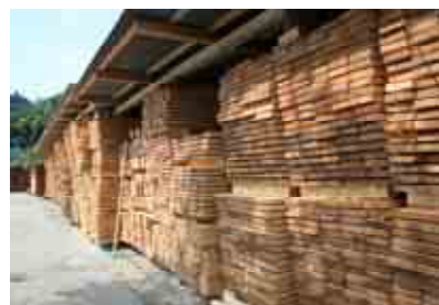
床板材（ヒノキ）の乾燥状況
