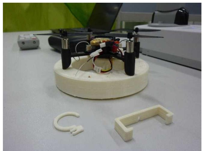
図16 飛行ロボット用オリジナルパーツ
