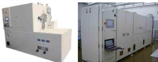
低欠陥のサファイア上AIN基板作製を実現している熱処理装置(左)
