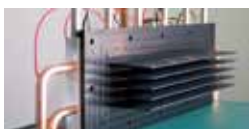
いわき明星大学が開発した熱電変換式温度差発電機
