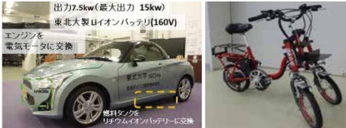
2. リチウムイオン電池の、小型電気自動車への搭載試験
