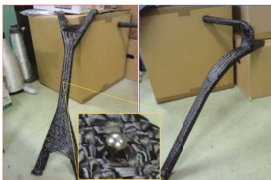
組物技術を活用した複合材料の構造部材への適用 （写真中央は、繊維を切ることなく作りこまれた結合孔の様子）
