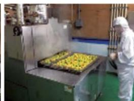
梅生果の過熱水蒸気加工
