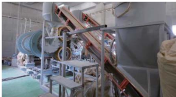
特徴ある木材微粉砕物を生産するタンデムリング型微粉砕機
