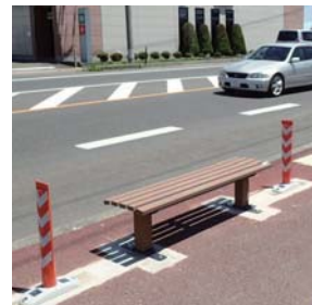
長期暴露試験のために 野外に設置されたベンチ
