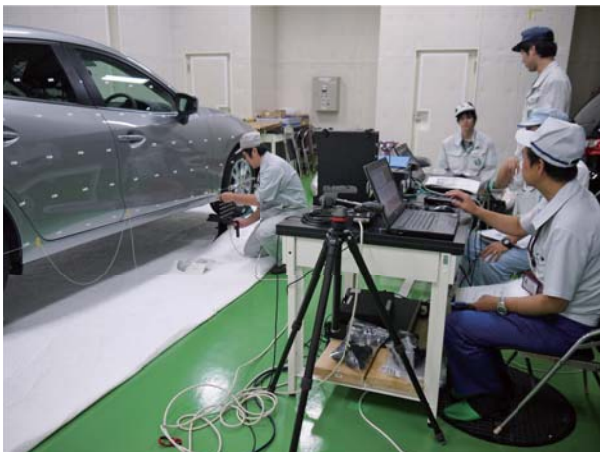
静粛性の高い自動車を目指した遮音性能評価
