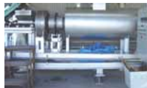
廃棄物炭化処理(還元熱処理)装置 (ロータリーキルン)
