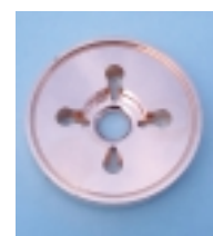
超精密加工された加速管セル
