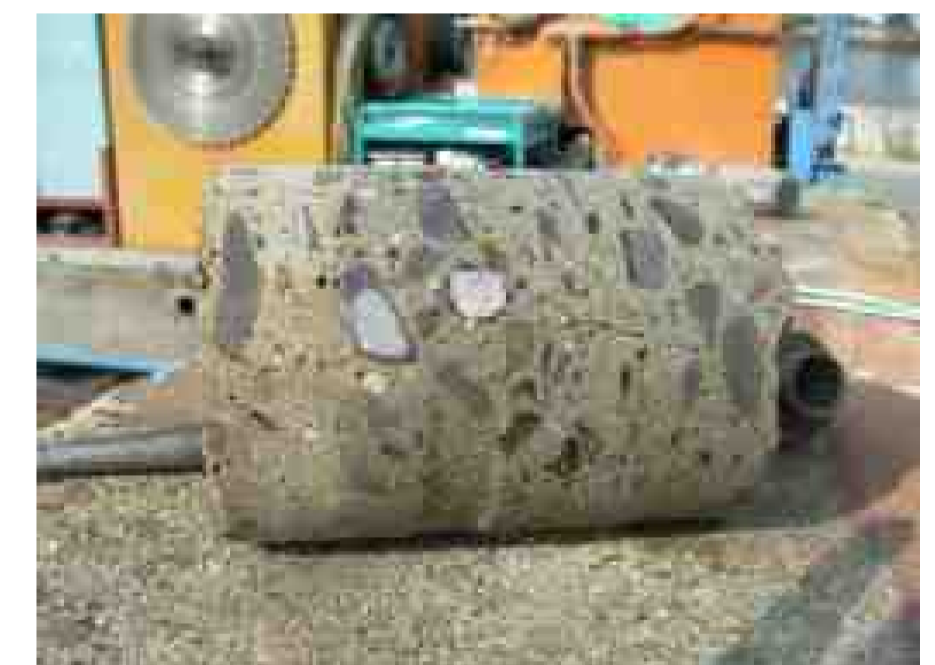
写真2 コア抜きしたコンクリート試料
