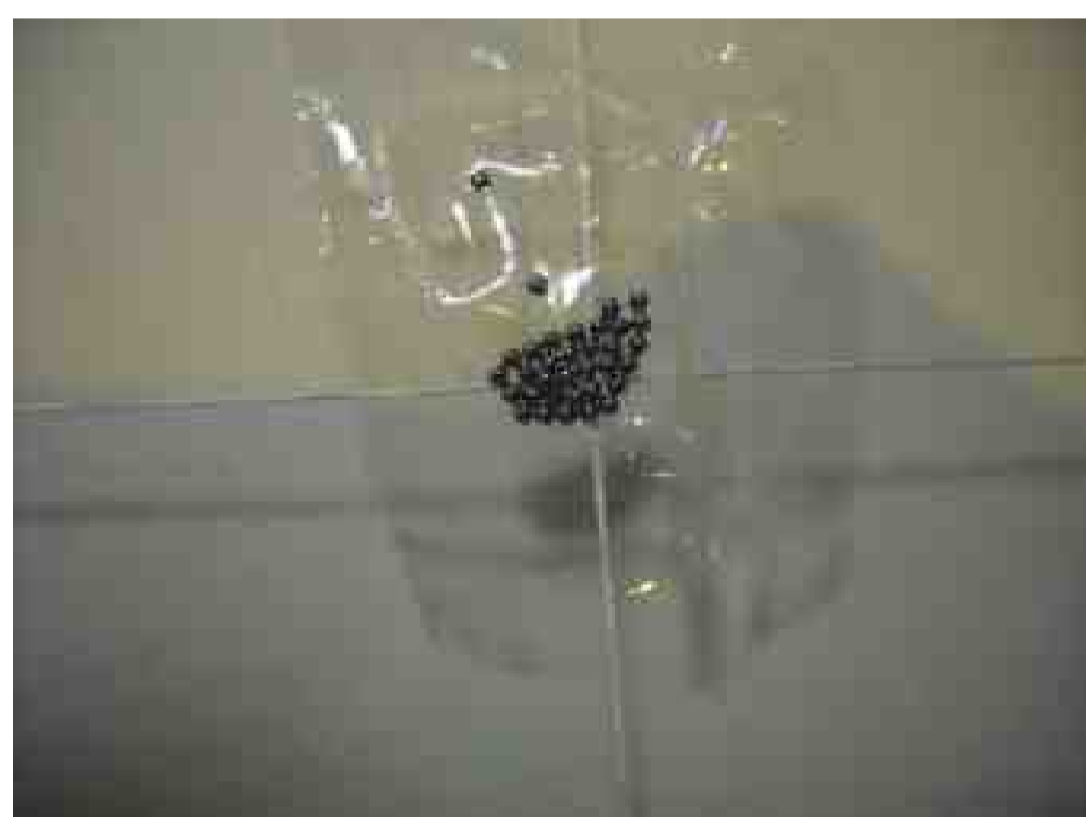
図2 PGAのためのボールペンのペン測定試料とその設置の様子
