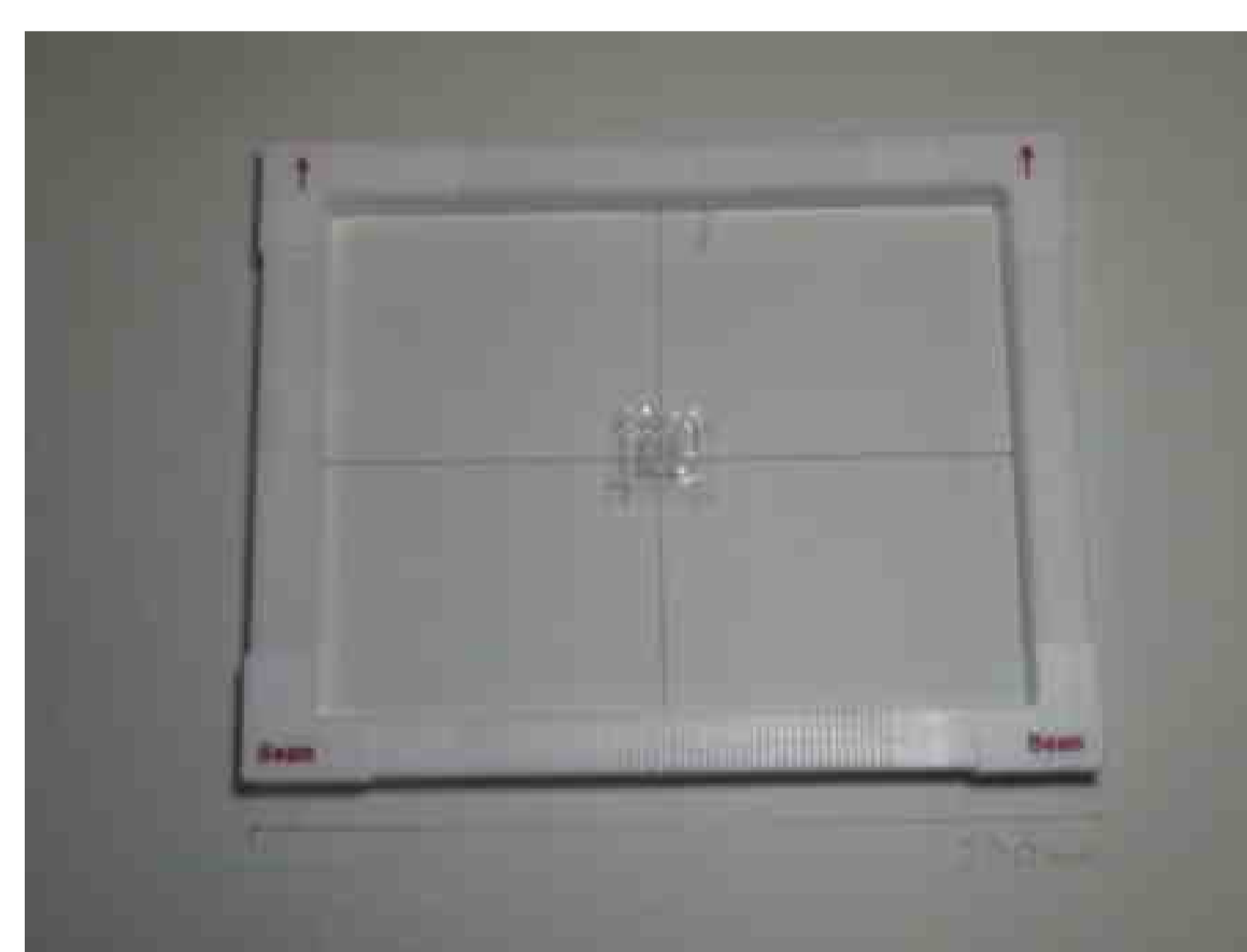
図2 Li 2 B 4 O 7 単結晶をテフロン製測定フレームにセットした様子
