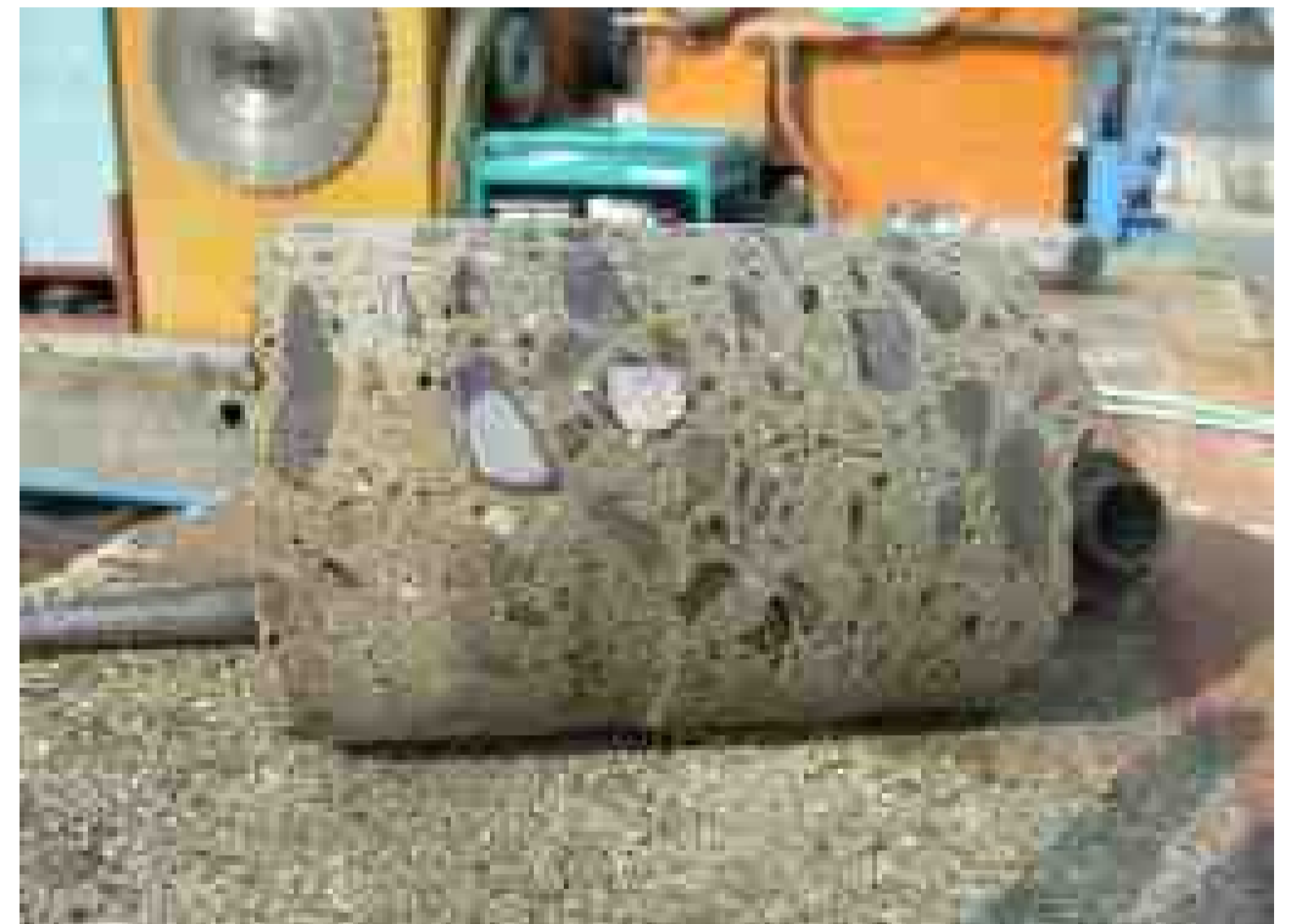
写真1 コア抜きしたコンクリート体。
