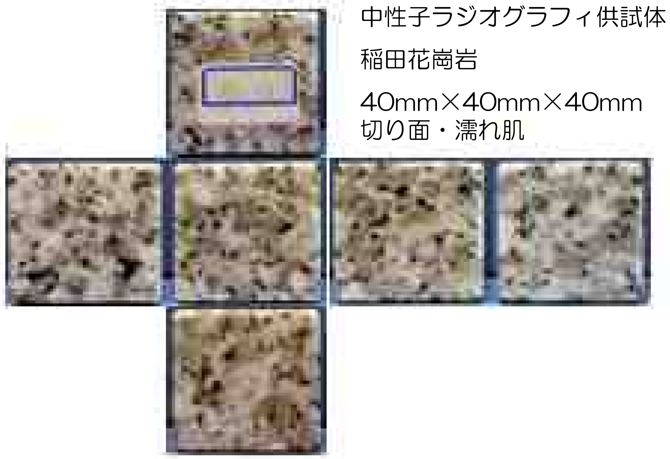
中性子ラジオグラフィ供試体 G614 40mm×40mm×40mm 切り面・濡れ肌
