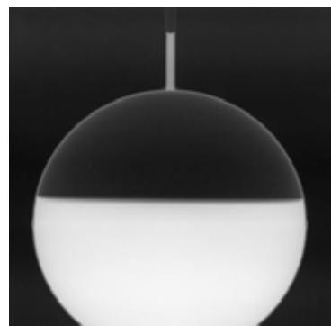
図4 推進薬チタンタンクの中性子ラジオグラフィ画像
