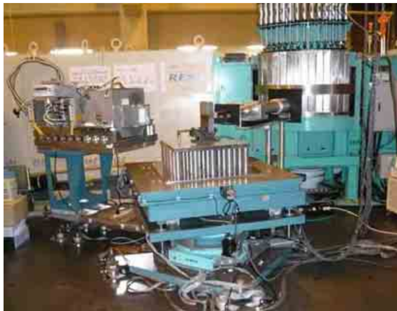
残留応力解析用中性子回折装置 (RESA)
