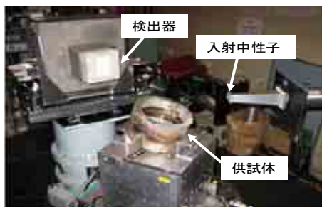
図3 RESA装置による残留応力測定の様相
