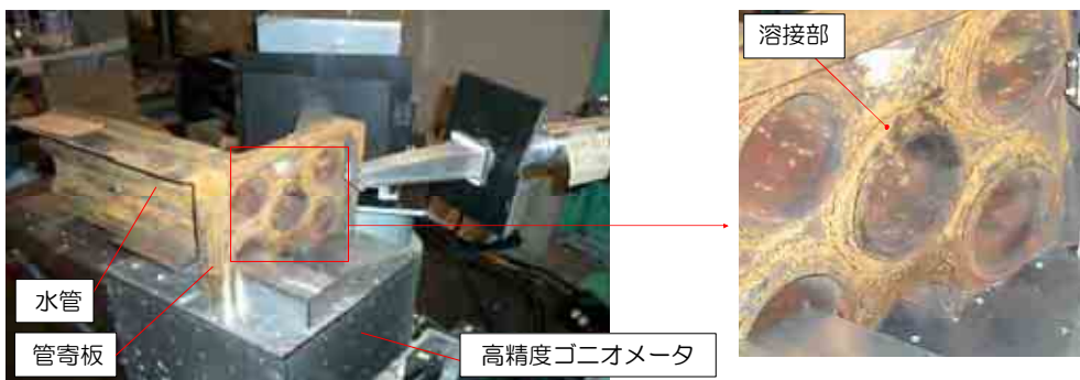
図1 試験体外観形状及び計測状況（写真は周方向応力計測時）
