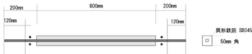
図-5 付着用試験体概要
