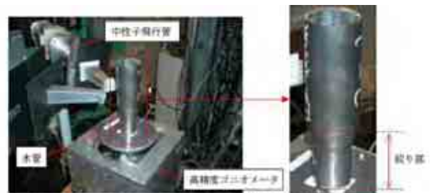
図1 試験体外観形状及び計測状況（写真は半径方向絞割（1/2寸計測時））
