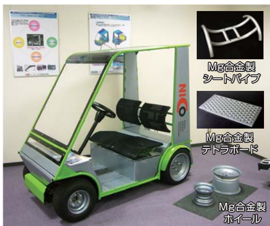
図4 試作Mg合金製電動カートと加工部品
