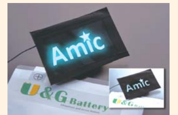
開発した二次電池によりEL照明が点灯
