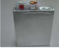
2. プレス成形可能な炭素繊維強化アルミニウム合金開発では、Al合金のめっき炭素繊維複合化により、元材料の板材よりも高強度(2倍の引張り強度)の複合材料を得ることができ、90度曲げ部分を含む成形体を作製した。
