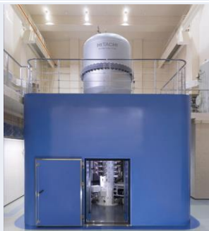
超高分解能 (～43pm), 厚膜透過, 磁場 (≥500mT)
