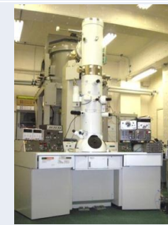
高分解能 (～170pm), エネルギー分析像, 試料への光または電子の照射
