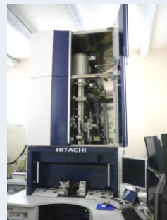
高分解能 (～200pm), 試料の加熱・冷却, 電圧印加, 磁場印加(～120mT)
