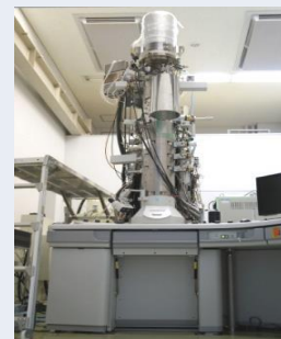
高分解能 (～200pm), 試料の加熱・冷却, 電圧印加, 磁場印加(～50mT)
