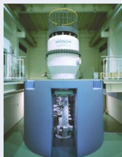
高分解能 (～120pm), 厚膜透過, 極低温+磁場
