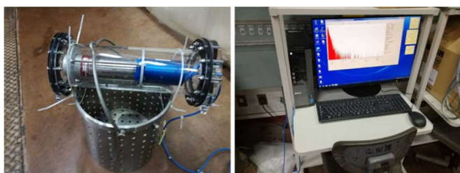
図 8 シンチレーション検出器を用いた水中での微弱放射線計測
