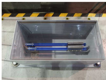
図5 耐震実習 （教材試験体：流体構造連成学習用）
