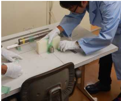
図 1 原子炉物理実習 （中性子源を用いた中性子の減速特性）
