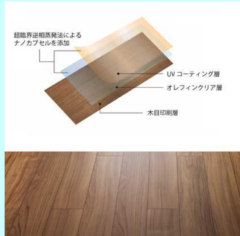
「Smart NANO®」による床材シートの構成(上)とその施行例(下)
