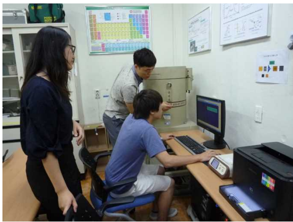
写真6 慶熙大学校原子炉実習（平成27年度） （放射化法による炉内中性子束分布測定）
