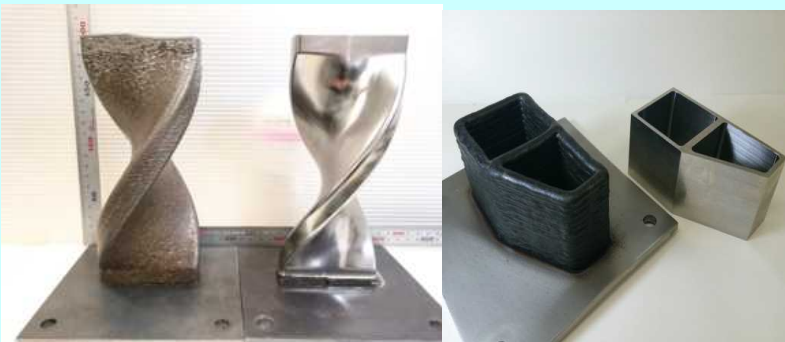
図2 本装置による造形事例(左)と切削表面(右)
