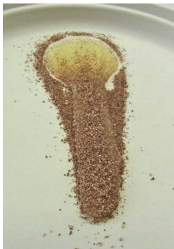
図) コンデンスミルクとココアによる溶岩実験: 冷却して砕けた岩をのせのまま流動する溶岩の様子がうまく再現できる。
