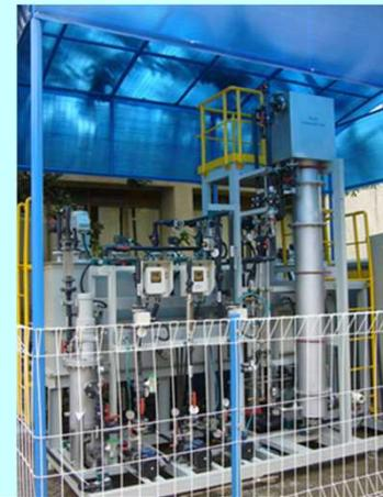
写真2 バンドンの浄水場に設置された浸漬膜法システムのパイロットテスト装置
