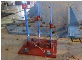
図3 耐震実習 (教材試験体)
