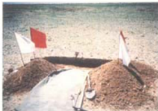
地雷の探知 (金属探知器が反応した後、人力で土砂を シャベルで除去し、地雷の存在を確認する)
