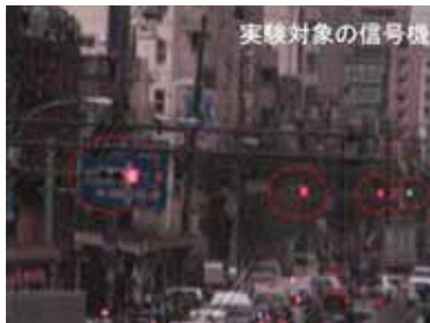
また、2009年2月には、カシオ計算機株式会社、日本電気株式会社、日本信号株式会社、株式会社東芝が、日本信号の久喜事業所において行なった。これは日本信号が用意したLED信号機から約160m離れた場所に、各社のイメージセンサ受信機（可視光通信の受信部にカメラ等に利用されている「イメージセンサ」を搭載した受信機）などを設置し、LED信号機から送信されるデータを受信するという実験であった。なお、本実験に先駆けて行われた予備実験では、約260mの距離での通信にも成功している。
