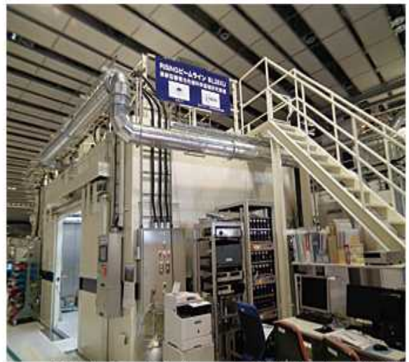
SPring-8に設置したビームライン(BL28XU) 電池内部のメカニズム解明により蓄電量向上に貢献M
