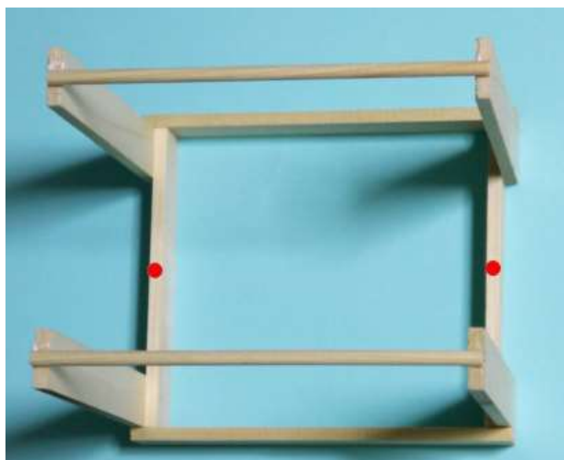
図5 振子を吊るすための木枠
