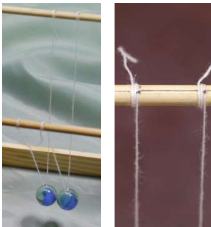
図7 2本の丸棒からV字形にぶらさげた振り子
