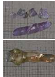
図1 FZ法により育成したNd:GdVO 4 単結晶と無添加GdVO 4 単結晶
