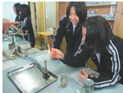
▲ 燃焼実験でプラスチックの性質を調べる
