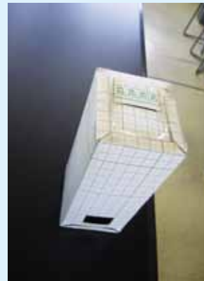
厚紙とCDで作った分光器（上部にスリットを開け、下の穴の中にCDを斜めに取り付ける）
