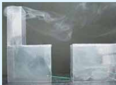
②線香を使って実験 (温度差を利用した換気)
