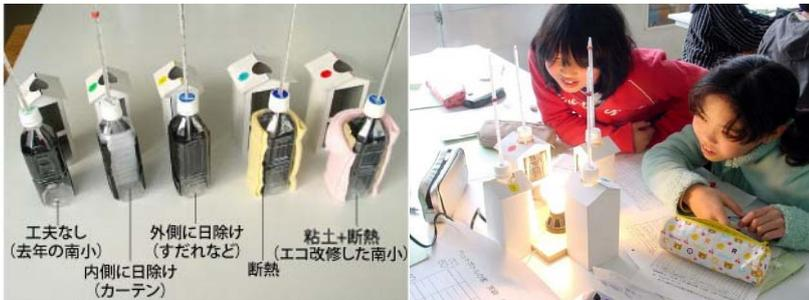
改修校舎の断熱や日射遮蔽の効果について学ぶ。様々な省エネの工夫を施したペットボトルの家を用意し、白熱球(太陽に見立てる)の点灯時と消灯後の温度変化を記録し、工夫の効果について考察する。
