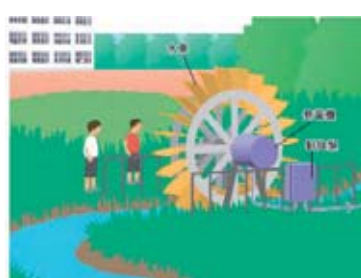
下掛け水車方式の小水力発電システム概要図
