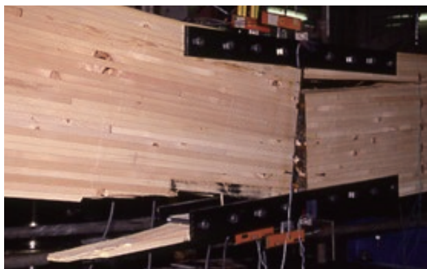
図 4-16 木材繊維に直交方向応力を受ける破壊
