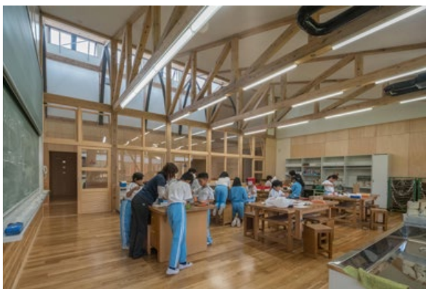
図 5-18 特別教室棟の架構（下弦材は集成材）
