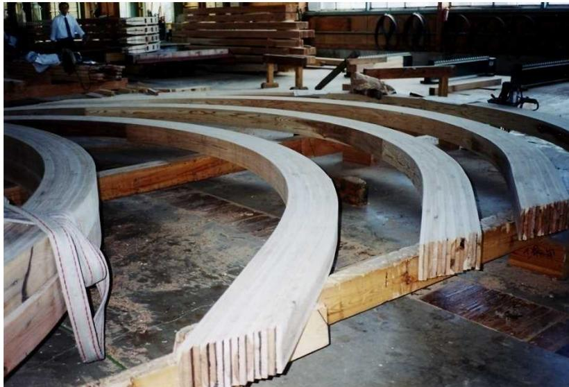
構造用集成材-接着・曲げ加工
